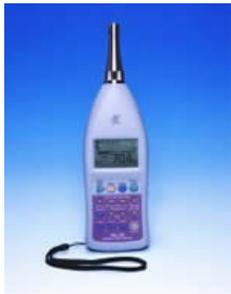
Der Zeitaufwand für eine Messung ist abhängig von der Art der Analyse: Einige Sekunden bis Minuten für die Messung des Schalldruckpegels einer isolierten Schallquelle (Auto, Preßlufthammer, stark befahrene Straße). 30 Minuten bis mehrere Stunden für die Messung des Grundgeräuschpegels (abhängig von den typischen Geräuschen des Messortes, z.B. Rhythmus von Verkehrsmitteln).
