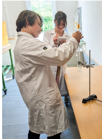
Niša Lutschaunig und Katrin Berlakowitsch (1WKW) bei der Ermittlung der Viskosität von Wasser mittels Viskosimeter
