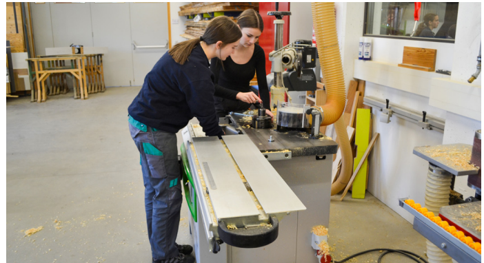
Yvonne und Johanna beim Werkzeugwechsel an der Tischfräse
