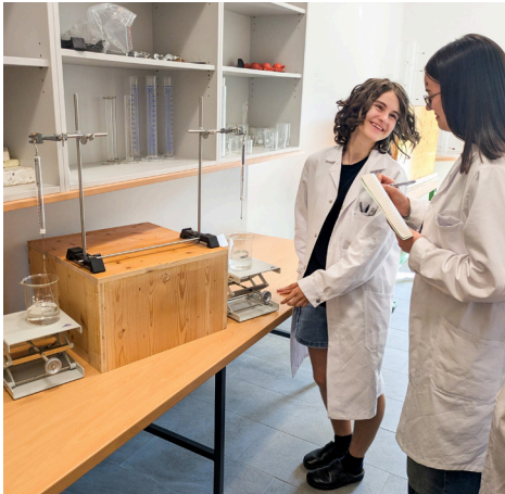
Nadine Müllner (links) und Mia Gerstorfer (rechts) bei der Ermittlung der Oberflächenspannung von Flüssigkeiten mittels Ring-Methoden Tensionsmeters
