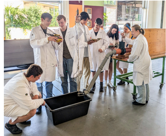
Schüler*innen der 1WKW bei der Ermittlung der Geschwindigkeit des austretenden Wasserstrahls aus dem Modell eines Staubeckens mittels hydrometrischen Flügels
